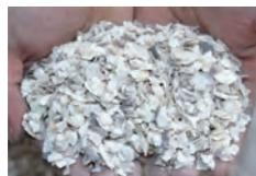
カキ殻を濾過材に使用して実験を繰り返した結果、従来型に比べて2倍の能力があることが判明。この装置をタイ南部・ナコンシタマラート県に持ち込んで検証実験を続けています。
